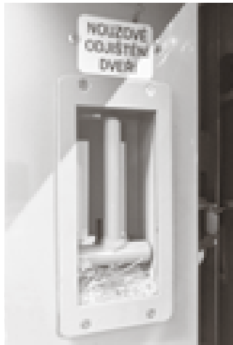
Poškozená skleněná výplň nouzového odjištění dveří vagonu.
