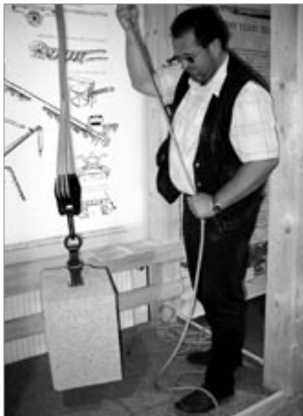
Ing. Jiří Moučka zkouší kamenický kladkostroj
