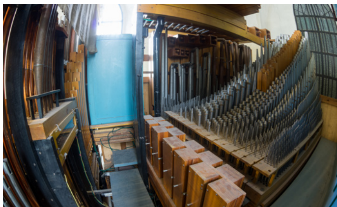
Část píšťalového stroje a pneumatické ovládání zásuvek.
